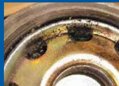
Fig. 2: Cartuș cu agent de uscare cu filtru coalescent după 60.000 km
