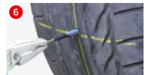
Am Schaft nachfassen und einziehen bis Teller anliegt
