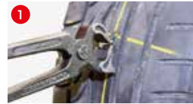
Fremdkörper entfernen / Bereich reinigen / Schaden markieren / Schadensgröße messen
